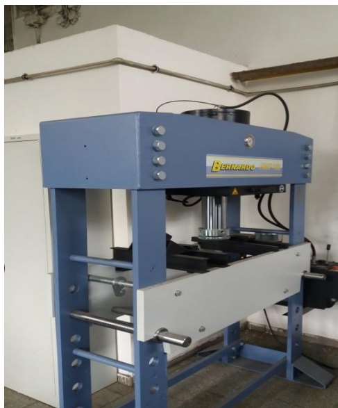
Hydraulický lis pro destrukční zkoušky svarů
