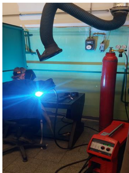
Programovatelný invertorový svařovací zdroj pro svařování metodou MIG/MAG
